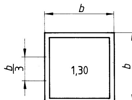
$$b_{\min} = 5,6 \text{ mm}$$
