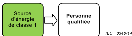
Figure 16 – Modèle pour protéger une personne qualifiée contre une source d'énergie de classe 1
