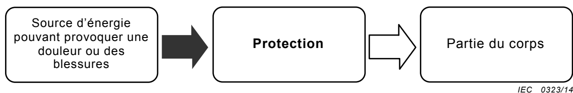
Figure 2 – Modèle en trois blocs pour la sécurité
